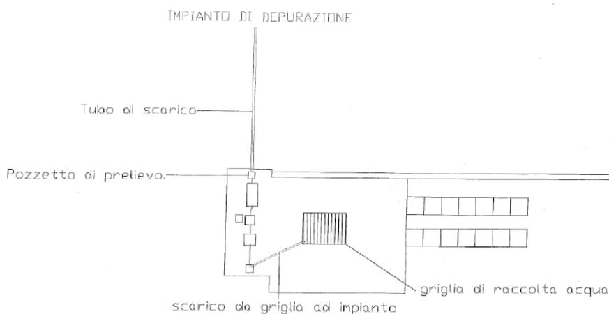
Figura n. 11 - Layout in pianta dell'impianto di depurazione fisico-biologico
