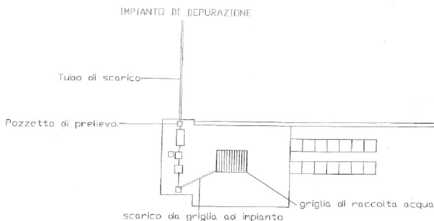
Figura n. 11 - Layout in pianta dell'impianto di depurazione fisico-biologico
