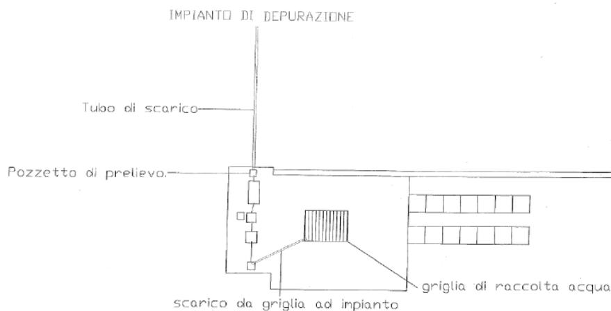
Figura n. 10 - Layout in pianta dell'impianto di depurazione fisico-biologico
